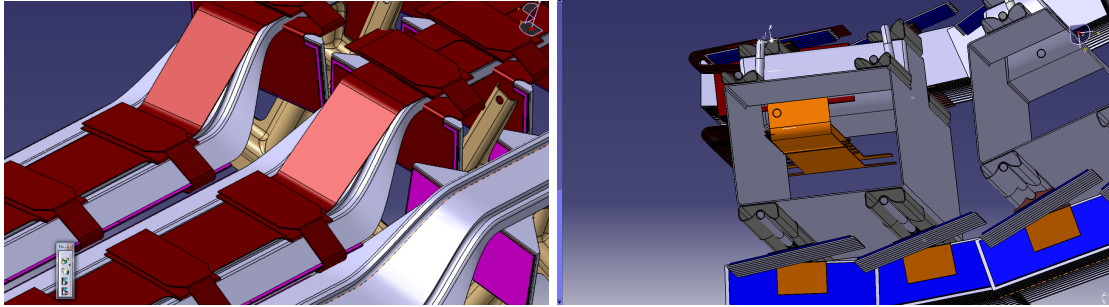
FIGURE 15 – Routage des services avec flexes du LAPP dans une structure de type Alpin (gauche) et de type SLIM (droite).
